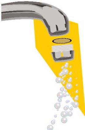
Utiliza perlizadores: si se adapta esta pieza a la grifería existente se conseguirá reducir el caudal de agua al mezclarse con aire y salir en forma de perlas
